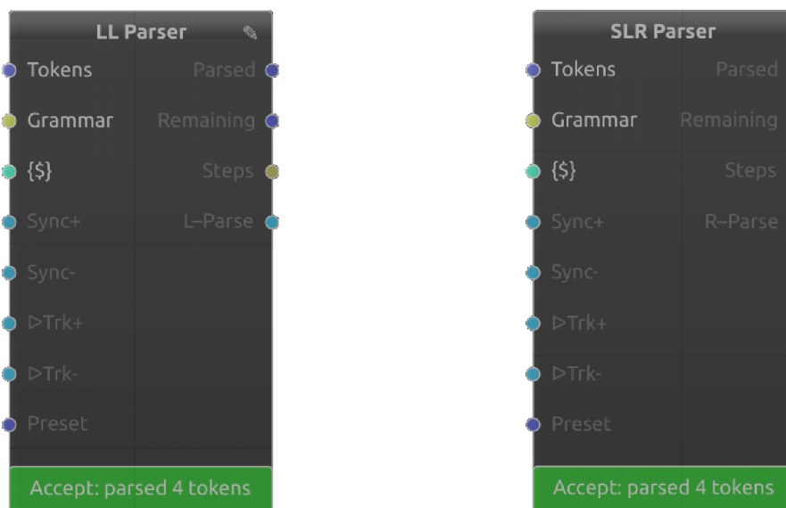
(a) Funkční blok LL Parser reprezentující komponentu typu LL . (b) Funkční blok SLR Parser reprezentující komponentu typu LR .
