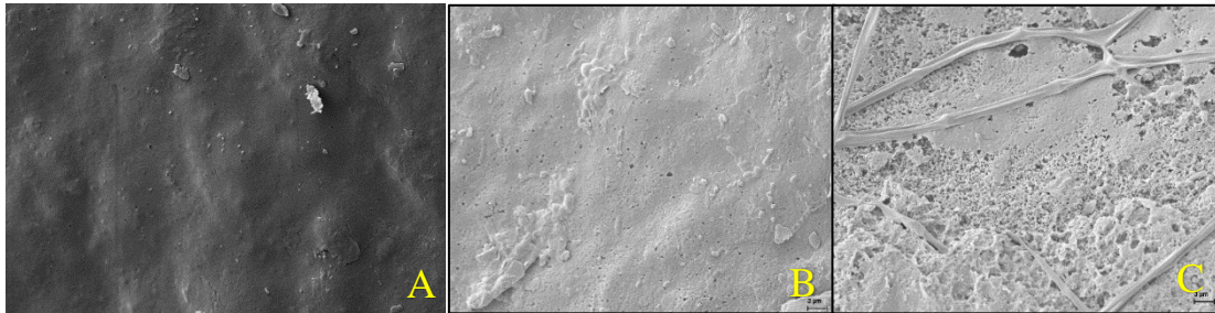
Obrázek 20: Snímek ze SEM povrchu PHB, A je snímek před experimentem, B z 4. a C z 8. týdne experimentu, povrch byl 5000x přiblížen
