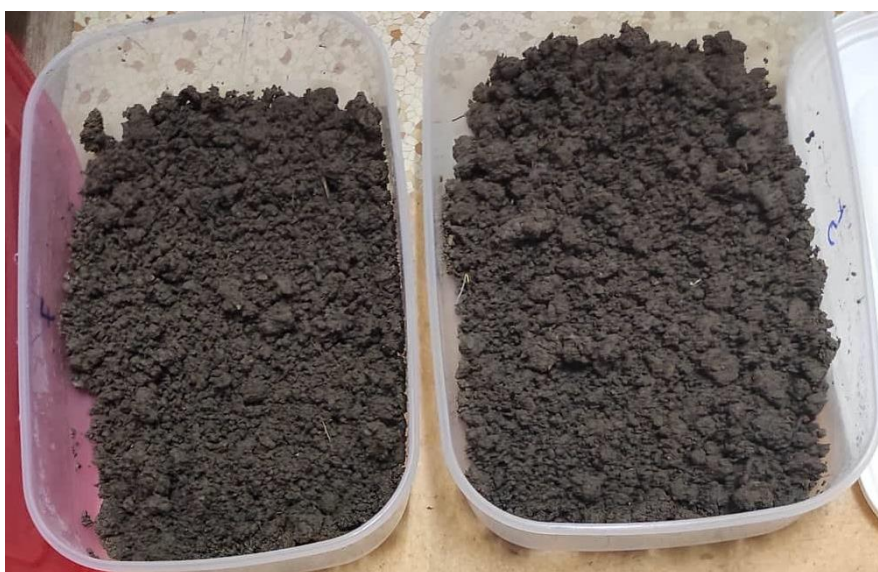
Obrázek 9: Prostředí půdy s polymery (převrstveny půdou) v době založení experimentu
