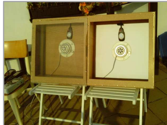
Obr. 37: Boxy s čidly, levý box krytý optickým rastrem
