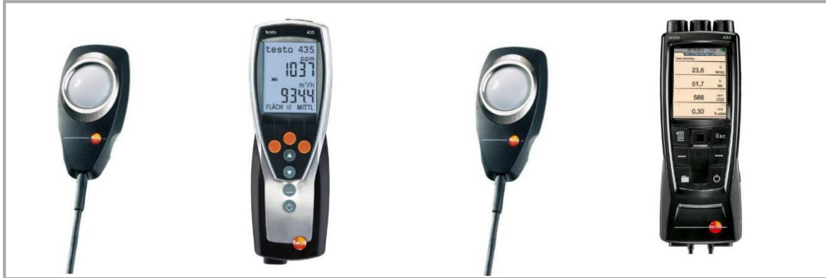
Obr. 33: Měřicí přístroje použité k měření intenzity osvětlení [20]
