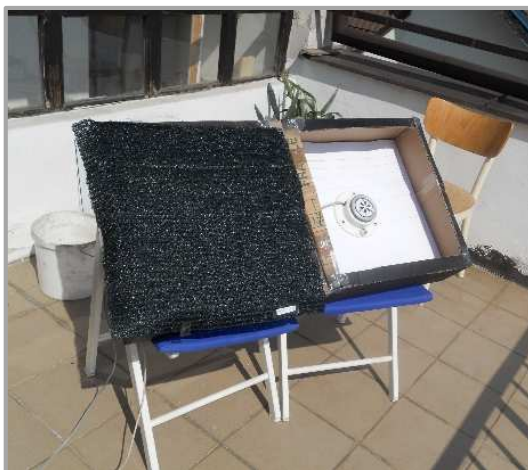
Obr. 43: Stanovení součinitele stínění
