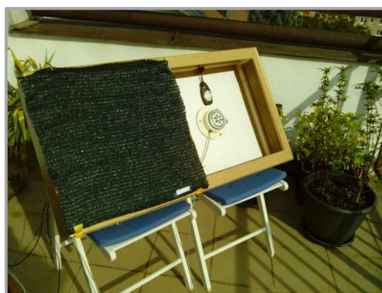
Obr. 39: Měření součinitele stínění
