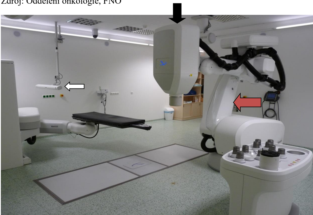
Příloha č. 2: Cyberknife, černá šipka ukazuje na lineární urychlovač, červená šipka směřuje na robotické rameno přístroje a bílá šipka poukazuje na LED kamerový systém. Zdroj: Oddělení onkologie, FNO
