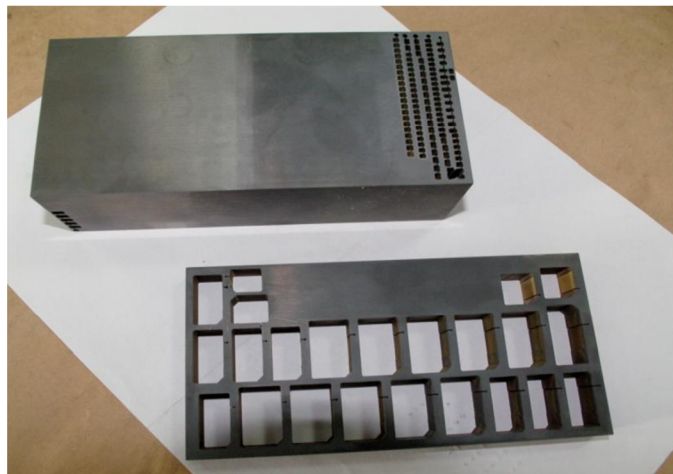
Obrázek 1.15 Bloky z těžkoobrobitelného tvrdokovu TSM30 vyřezané elektrojiskrovou technologií.
