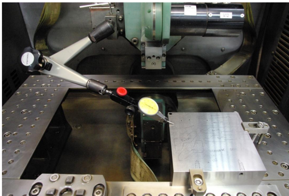
Obr. 5.6 Upnutí základního polotovaru pomocí upínek a vyrovnání úchylkoměrem.
