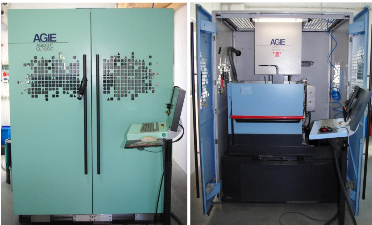
Obr.3.3 Elektroerozivní drátové řezačky AGIE CLASSIC 2 a AGIE AgieCut PROGRESS V2.
