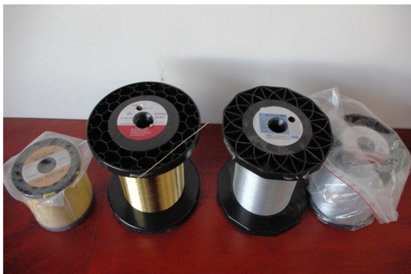
Obr. 1.18. Ukázka cívek mosazného a zinkem povlakovaného drátu.
