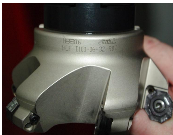
Obr. 5.2 Použitá čelní fréza s VBD destičkami.
