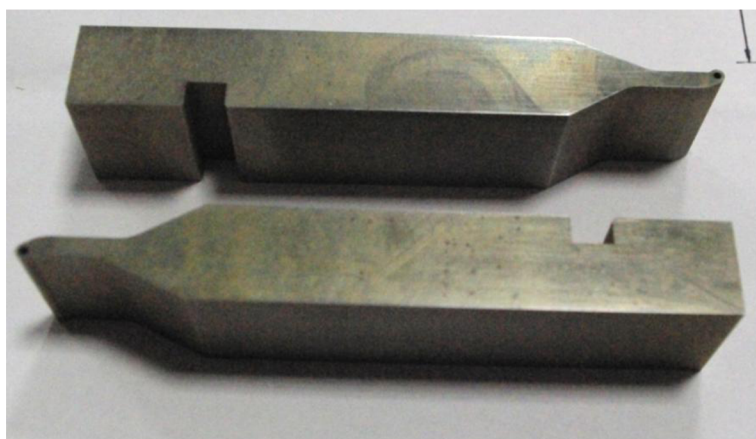
Obr. 5.10 Ohybník po první fázi řezání.
