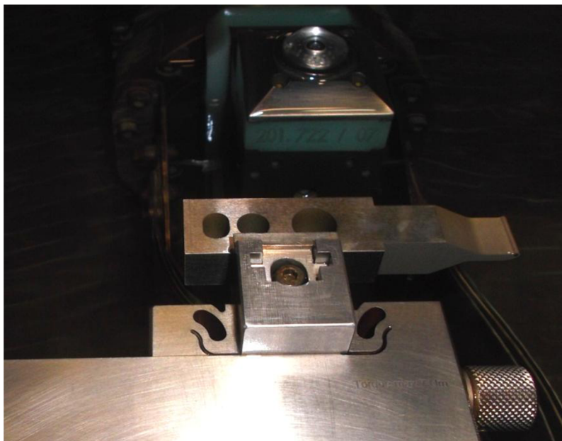
Obr. 5.12 Uchycení ohybníku ve svěráku a jeho výsledný tvar po ořezu.
