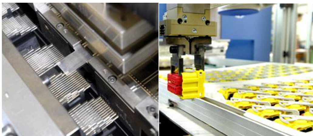
Obr.3.2 Ukázka ohýbací části a koncového balicího automatu výrobní linky konektorů. [11]
