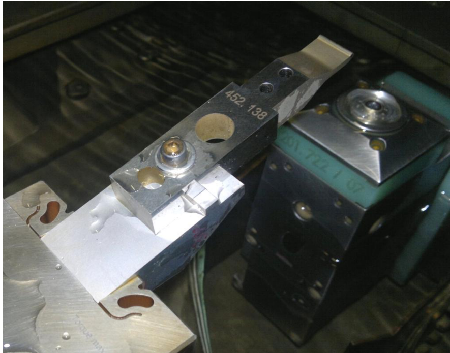
Obr.5.14 Upnutí ohybníku v jednúčelovém přípravku.
