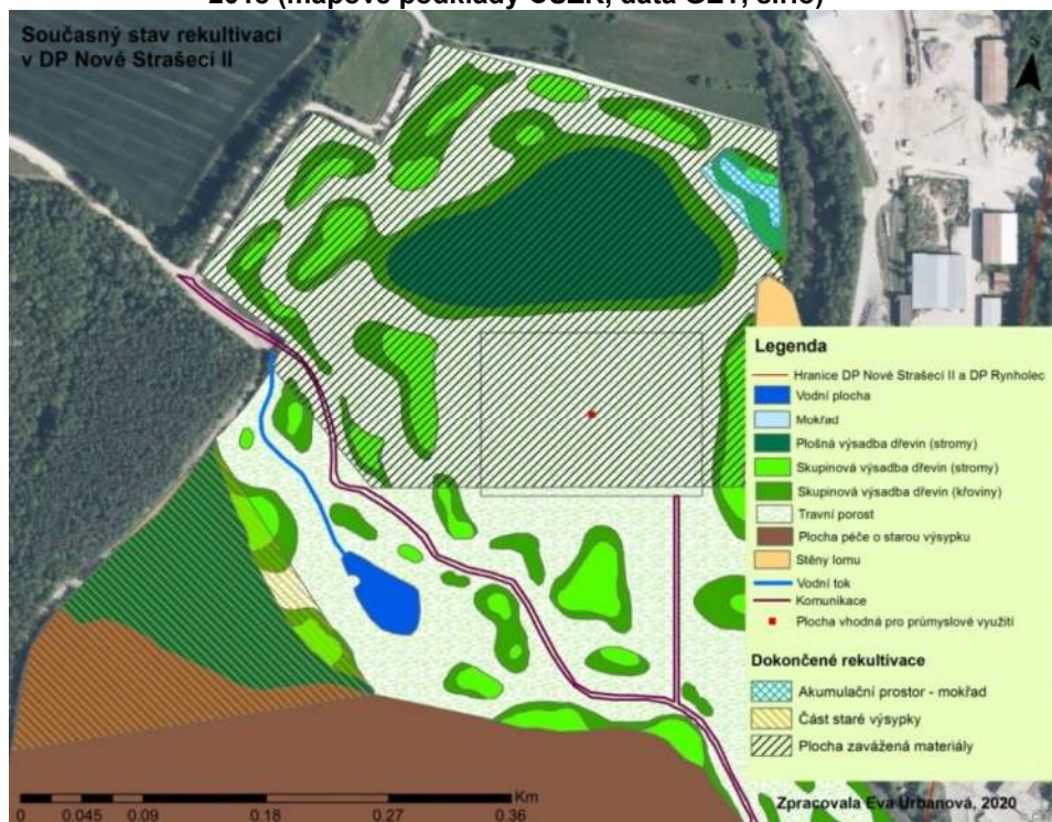
Obrázek 9: Mapa stavu rekultivací v DP Nové Strašeci II. vycházející ze Závěrečného vyhodnocení rozsahu prací v rámci sanace a rekultivace v letech 2014–2018 (mapové podklady ČÚZK, data GET, s.r.o)
