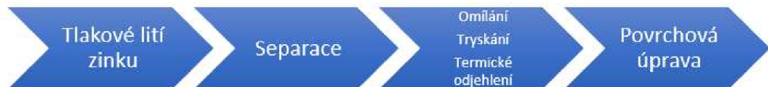
Obrázek č. 1: Schéma zinkového výrobního procesu. Zdroj: Vlastní zpracování
