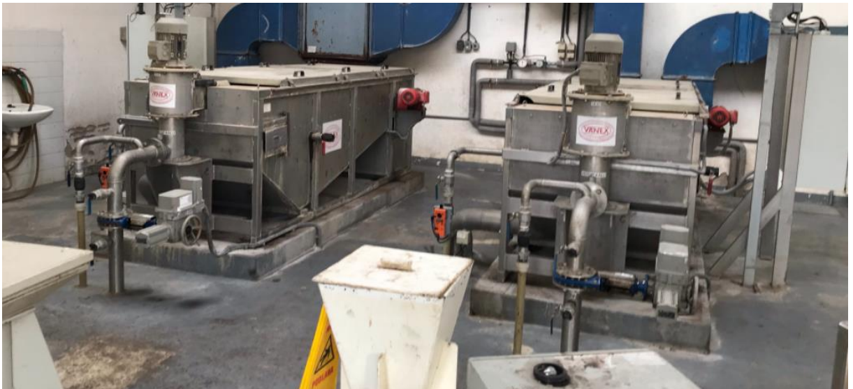
Obrázek 14 - Sítopásové lisy na ČOV Kolín (autor)
