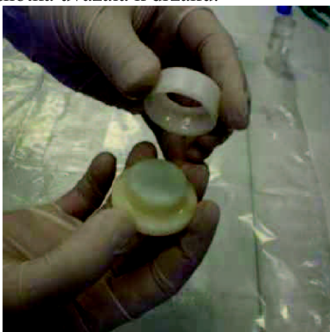
Obr. 33. Vzorkovací jednotka DGT – válcovitá a prstencová část jednotky.
