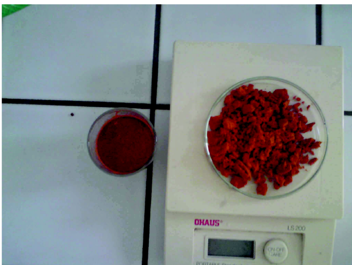
Obr. 29. Produkt diazotační a kopulační reakce.
