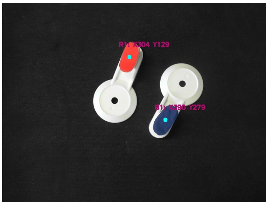
Obrázek 3.16: Zjištění těžiště jednotlivých kontur
