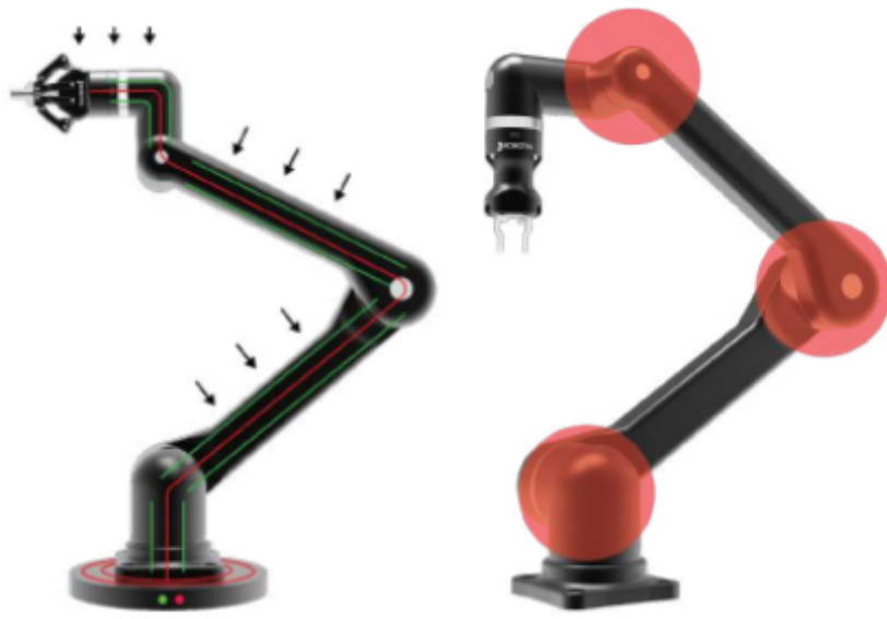
Obrázek 2.2: Využití momentových senzorů v základně a kloubech robota[8]
