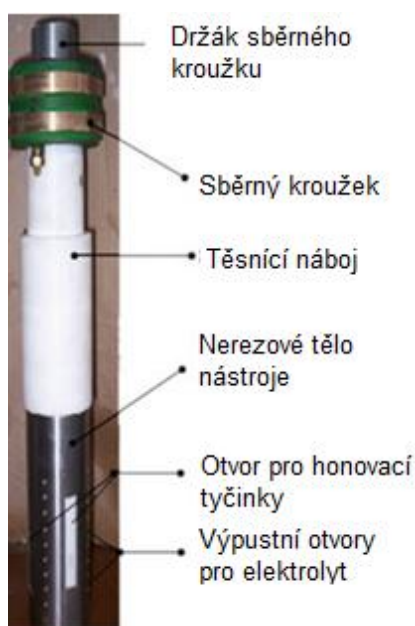
Obrázek 14 – Nástroj na elektrické honování (K. Gupta)
