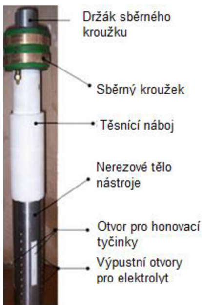
Obrázek 14 – Nástroj na elektrické honování (K. Gupta)
