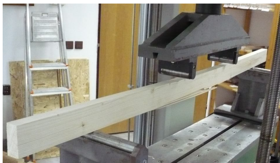
Obr.č. 62 : Odzkoušený nevyztužený nosník v ohybu
