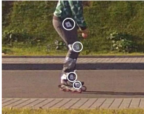
Obr. 2-3 Korčuliar s pasívnymi značkami (bedro, koleno, členok a špička korčule)
