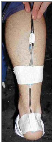
Obr. 1-12 Uchytenie elektronického goniometru [19]
