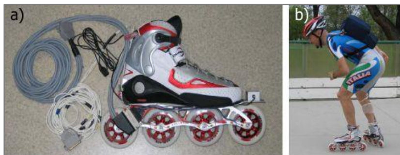
Obr. 1-15 Korčuľa použitá pri meraní sily [21] a) detailný pohľad na korčuľu, b) korčuliar s korčuľou
