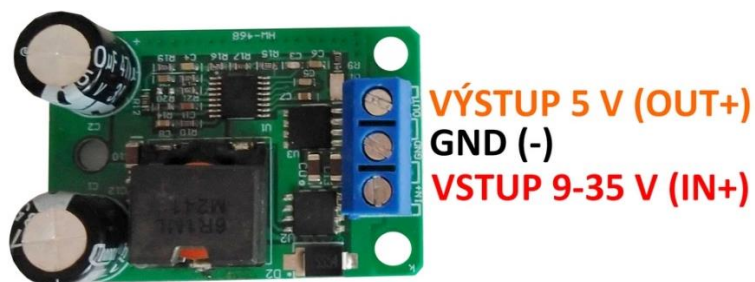
Obr. 20: Použitý stabilizátor napětí na 5 V
