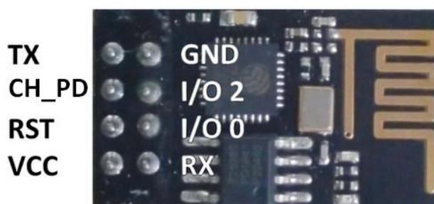
Obr. 14: Rozložení pinů základního ESP-01 modulu
