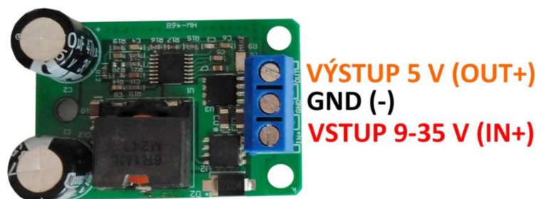
Obr. 20: Použitý stabilizátor napětí na 5 V
