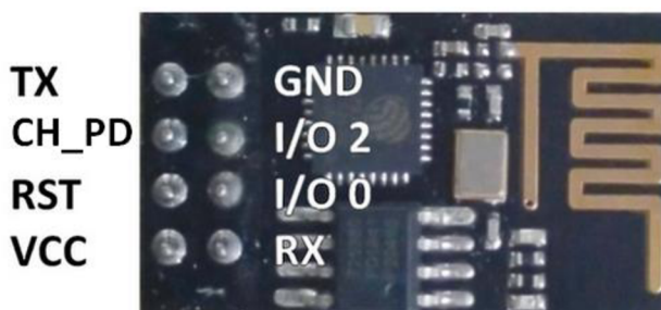
Obr. 14: Rozložení pinů základního ESP-01 modulu
