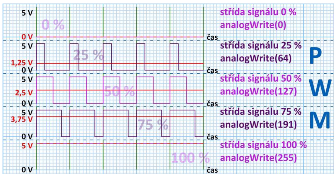
Obr. 3: PWM – střída signálu (duty cycle) a hodnota funkce analogWrite() 3
