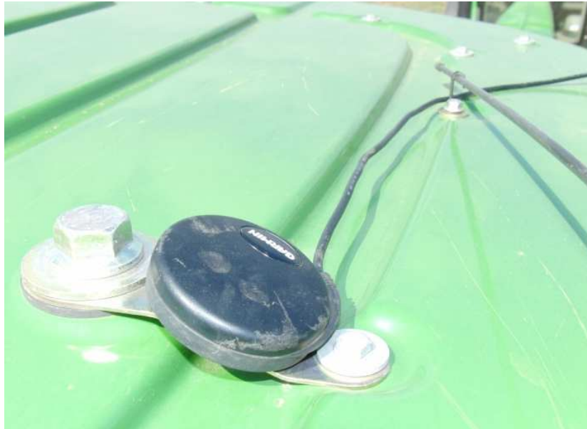
Obr. 15 GPS přijímač Garmin 18x – 5 Hz umístěný na kapotě traktoru John Deere (Čupera, 2016)
