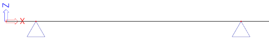
Obr. 11 Výpočtový model pro schodiště – provozní stav
