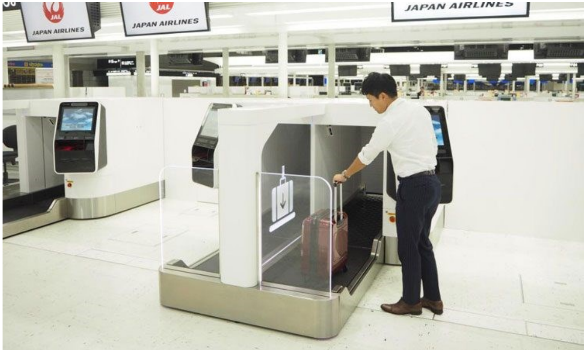
Obr. 3.1 System automatického odbavení zavazadla v Japonsku
