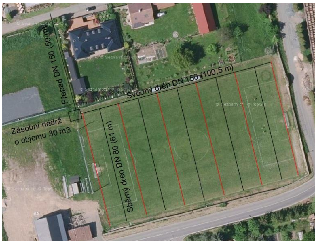
Obr. č. 27: Schéma drenážního systému hřiště pro neustálené drenážní proudění (mapy.cz, B, Autocad 2017)
