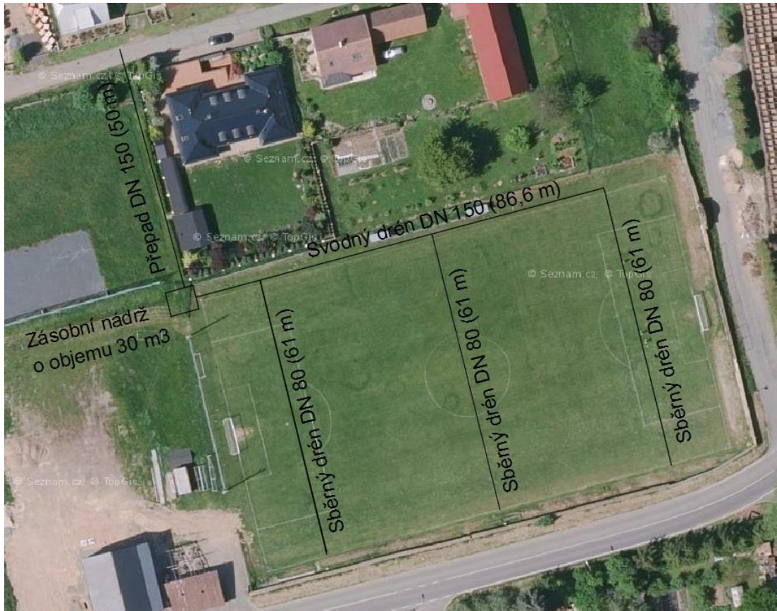
Obr. č. 20: Schéma drenážního systému hřiště pro ustálené drenážní proudění (mapy.cz, B, Autocad 2017)
