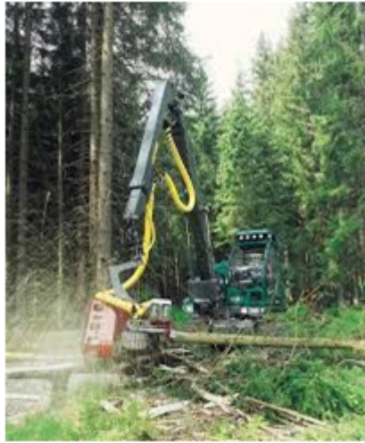
Obr. A.1: Použitý harvester Neuson Ecotec, typ 9002 HV.
