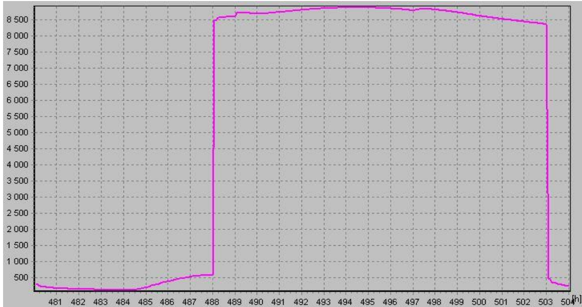
Obr. 18 grafické znázornění tepelné zátěže pro místnost 1.02
