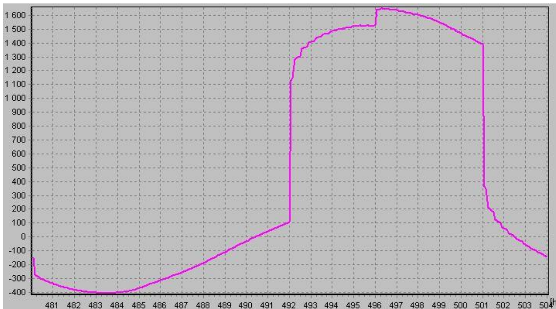
Obr. 17 grafické znázornění tepelné zátěže pro místnost 1.11
