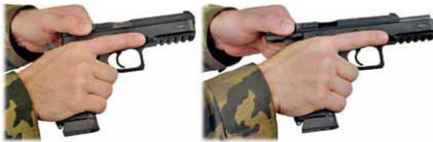
Obrázek 1 Natažení závěru palcem a ukazovákem
