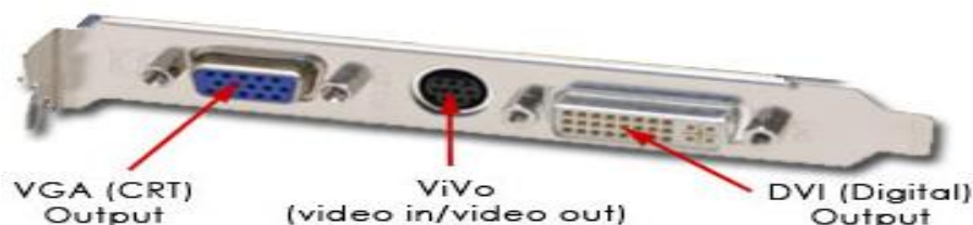
Obr. 17.: Grafické znázornění některých výstupů grafické karty [15]
