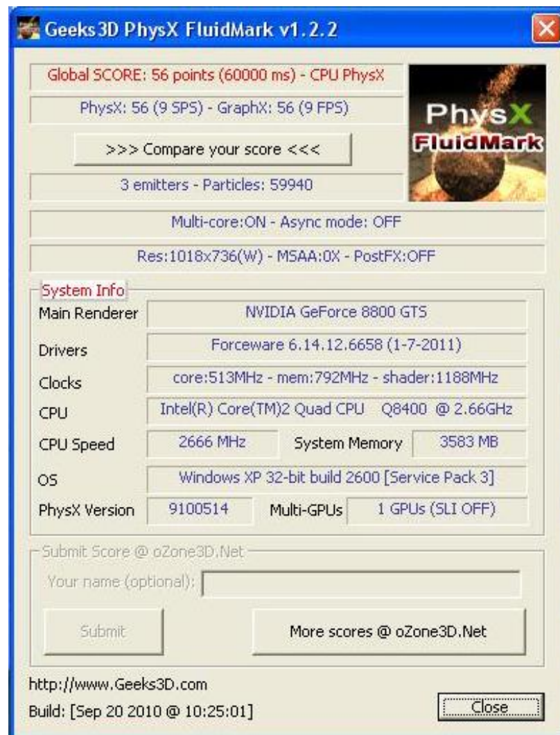
Obr. 62.: Testování grafické karty nVidia GeForce 8800 GTS
