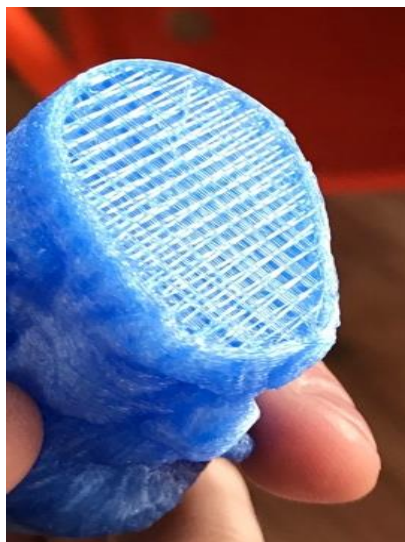
Obrázek 28 Řez modelem, vnitřní struktura, Kateřina Hájková 54
