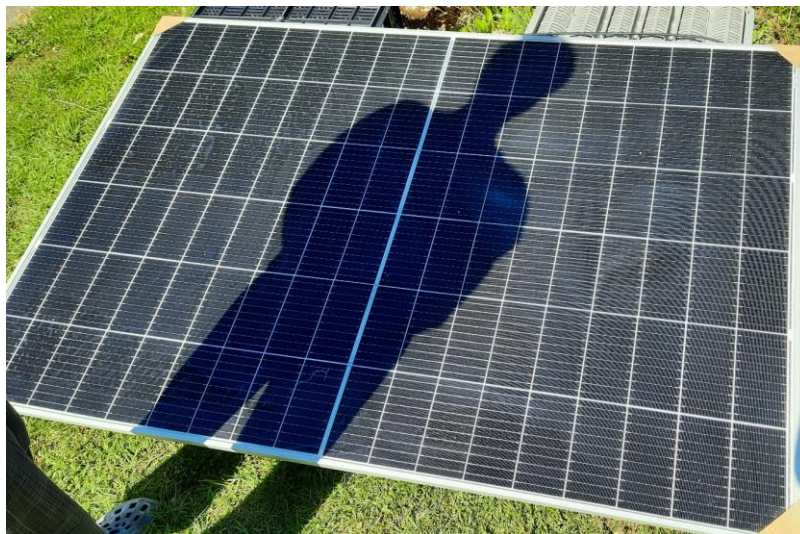
Obrázek 27: Zakrytí FV panelu nepravidelným stínem
