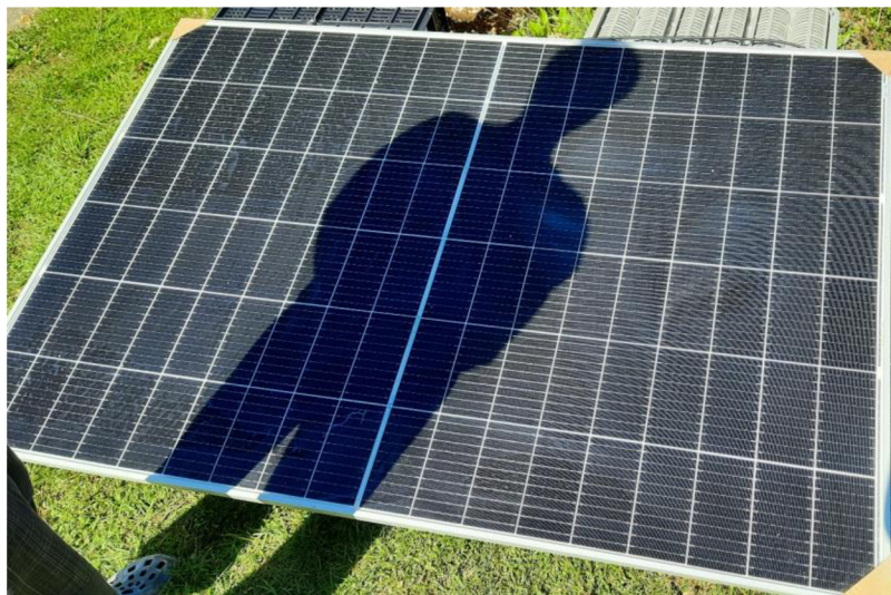
Obrázek 27: Zakrytí FV panelu nepravidelným stínem
