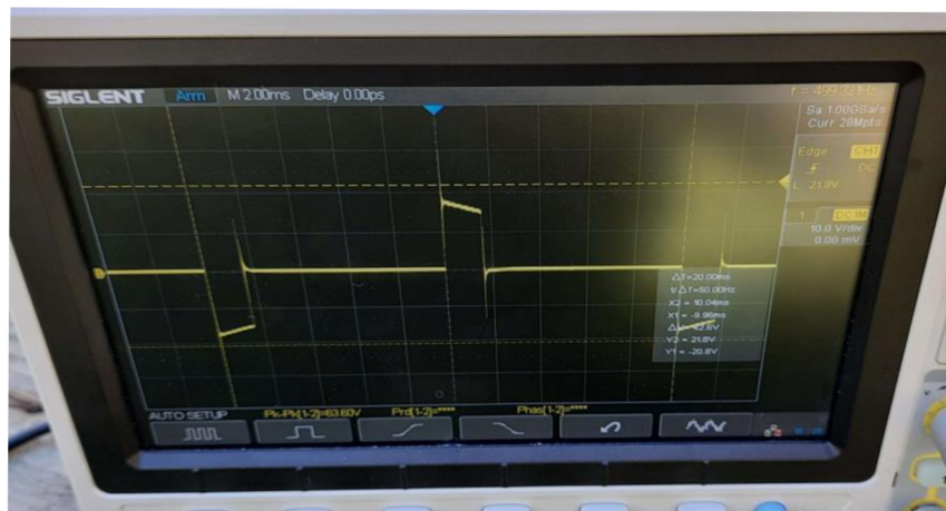
Obrázek 23: Výstup z osciloskopu pro velkou zátěž
