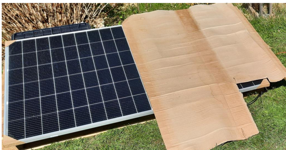
Obrázek 26: Zastíněn jeden sériový string FV panelu
