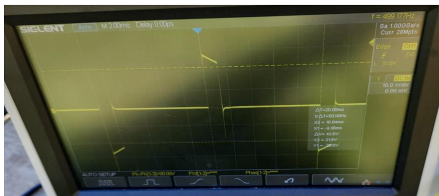
Obrázek 28: Výstup z osciloskopu pro nepravidelně zastíněný FV panel
