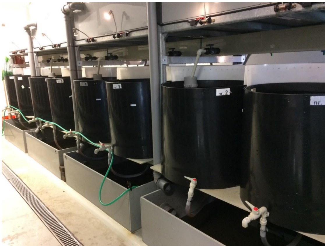
Obr. č. 1: Recirkulační systém pro experimentální odchov okouna říčního (foto Tran Quang Hung).
