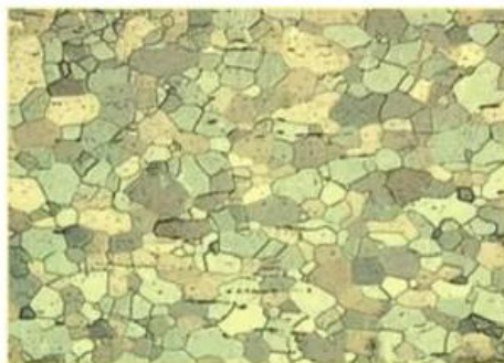
Obrázek 20 Struktura IF oceli [6]
