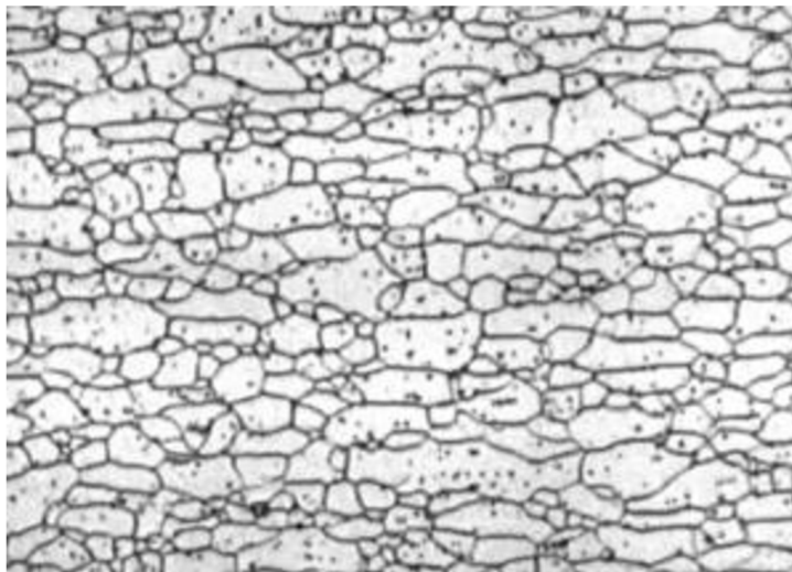
Obrázek 21 Mikrostruktura oceli HSLA 340 [6]
