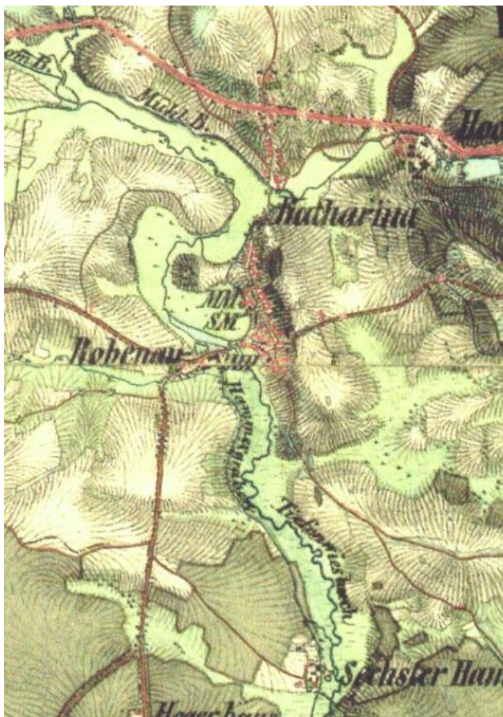
Obr. 18. Začátek mlýnského náhonu vlevo nahoře pod silnicí do Rozvadova se zakončením ve vodní nádrži. Z vodní nádrže náhon k 6. hamru, na obrázku dole zhruba uprostřed. Zdroj oldmaps © 2023, II. voj. mapování 1836-1852.
