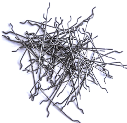
Obrázek č. 23: Ocelové vlákno s kotvícími konci (43)
