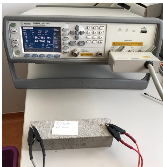
Obrázek č. 33: Měření pomocí přístroje Agilent LCR E4980A
