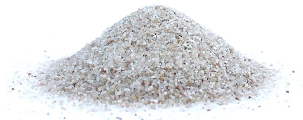
Obrázek č. 18: Křemičitý písek frakce 0-1 mm (32)
