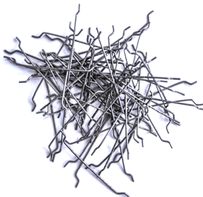
Obrázek č. 23: Ocelové vlákno s kotvícími konci (43)
