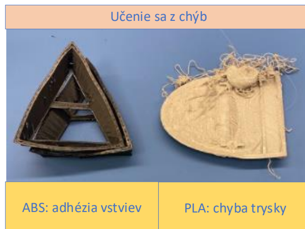
Obr. 52) Chyby pri tlači – chyby modelu.
