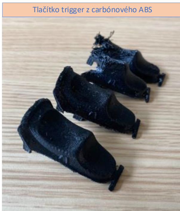
Obr. 53) Chyba dokončenia vrstiev v 3. a 4. diele.
