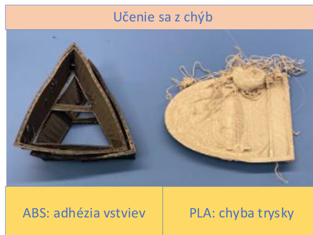
Obr. 52) Chyby pri tlači – chyby modelu.
