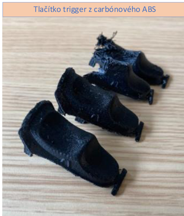
Obr. 53) Chyba dokončenia vrstiev v 3. a 4. diele.
