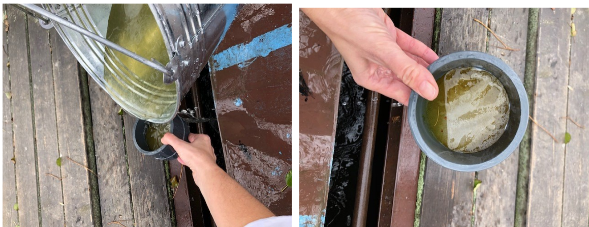
Obrázek 11 - Odběr vzorku E. - povrchová voda řeky Ohře na výstupu z vodní nádrže Skalka, odběr vzorku přes mikrosíto
