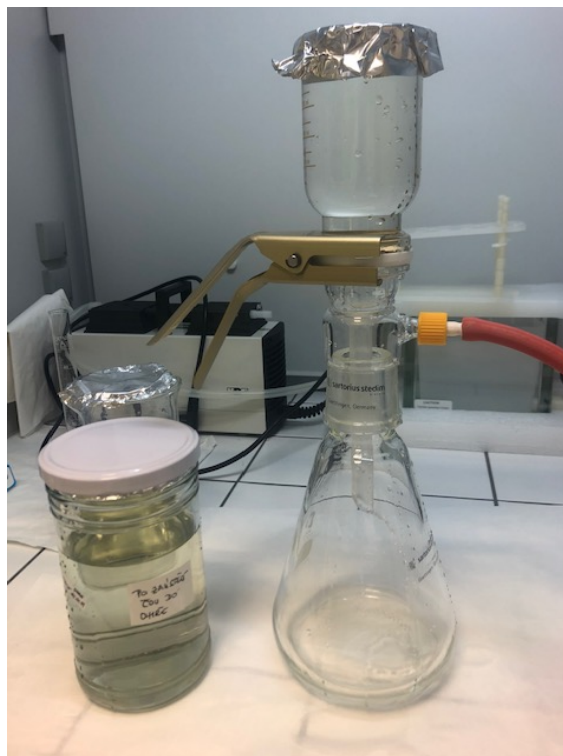
Obrázek 12 - Ukázka filtrace vzorku vakuovým filtračním zařízením Sartorius
