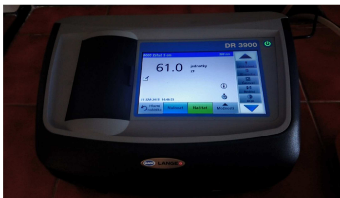
Obr. 9.5 Měření zákalu na spektrofotometru
