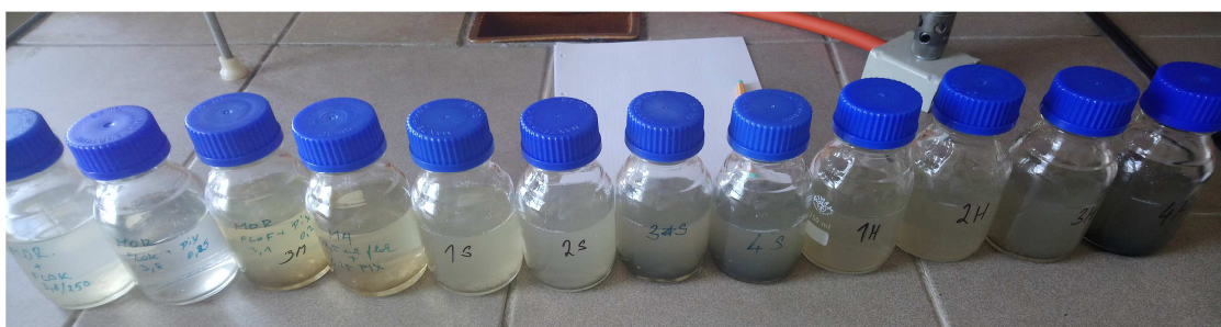
Obr. 10.4 Zákal filtrátu z aerobně stabilizovaných kalů
