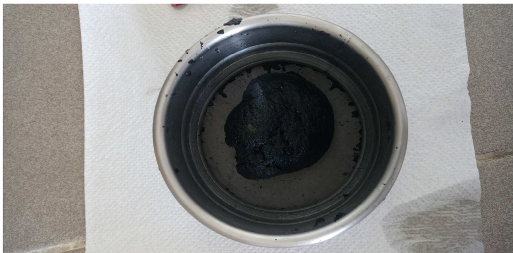
Obr. 10.3 Odvodněný kal po filtračním testu
