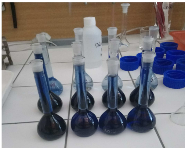
Obr. 10.8 Vznik molybdenové modře – anaerobně stabilizované kalý
