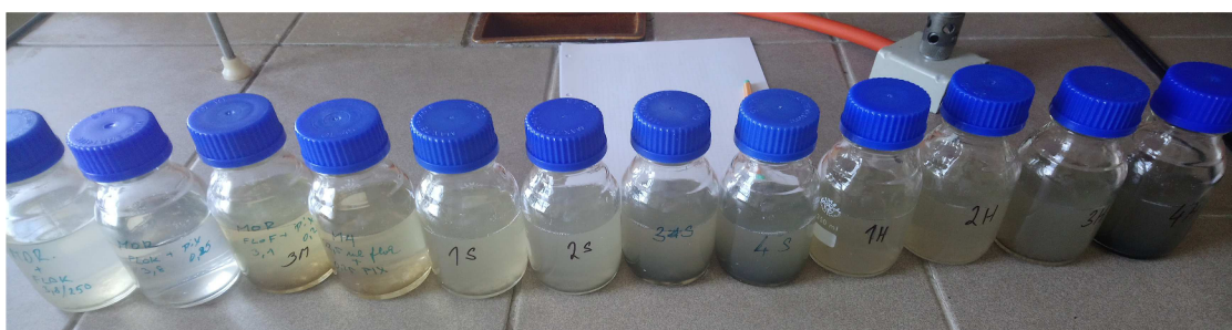
Obr. 10.4 Zákal filtrátu z aerobně stabilizovaných kalů
