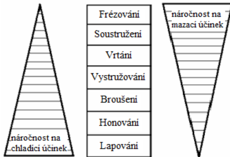
Obr. 16 Náročnost na chladicí a mazací účinek procesní kapaliny [22].
