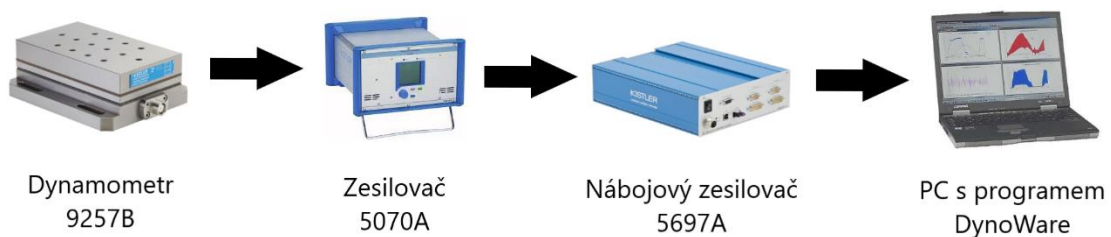
Obr. 35 Schéma zapojení dynamometru [40; 41].
