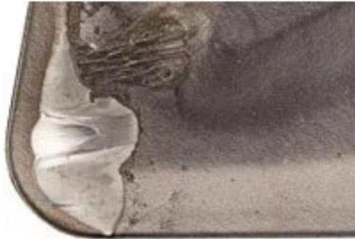
Obr. 30 Opotřebení ve tvaru žlábků na čele [35].
