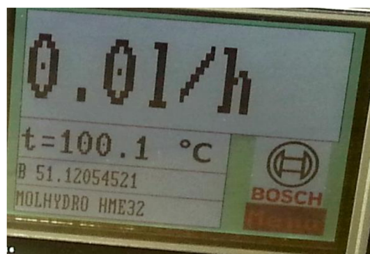
Obrázek 51: Po kalibraci 100 °C
