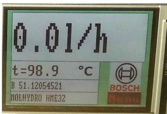
Obrázek 50: Před kalibrací 100 °C
