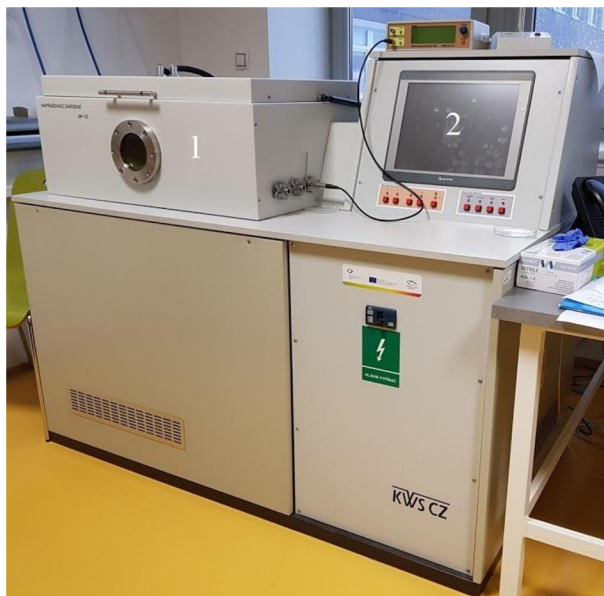
Obr. 6.2. Naprašovanie zariadenie NP12 od firmy KWS CZ: 1 – Pracovná komora; 2 – Ovládací systém
