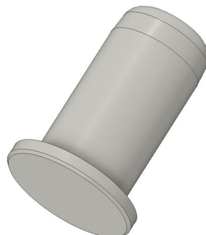
Obr. 30 Model předkovacího trnu
