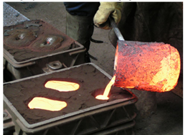
Obr. 4 Odlévání do pískové formy [21]
