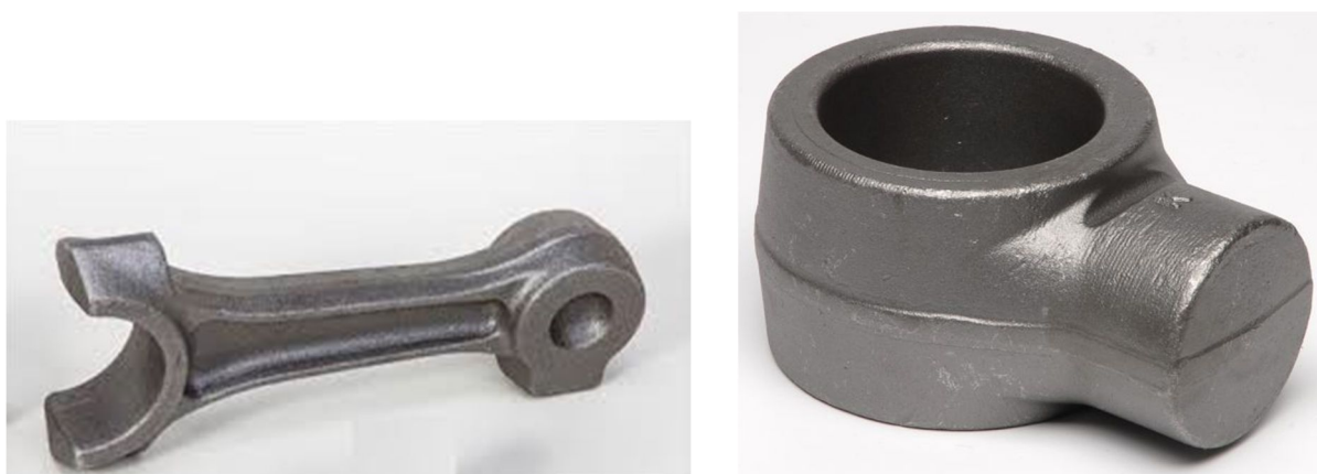
Obr. 1 Příklady výkovek zápusťkového kování [18], [26]
