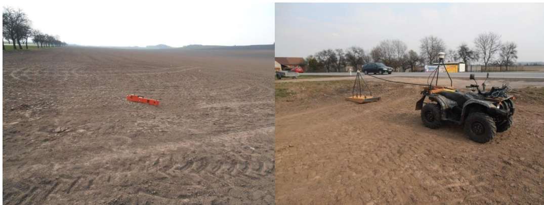
Obrázek 19: Sonda EM 38 MK2 (vlevo), terénní čtyřkolka s datovou ústřednou, GPS a saněmi pro uchycení sondy (vpravo)
