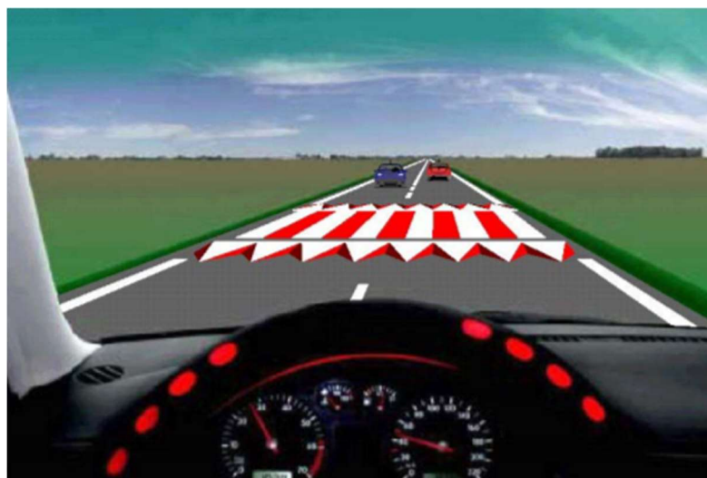
Obrázek 12 - 3D přechod ze vzdálenosti 10-15 m
