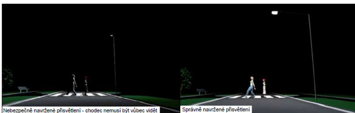
Obrázek 11 - Příklad nebezpečného a správného přisvětlení přechodu pro chodce
