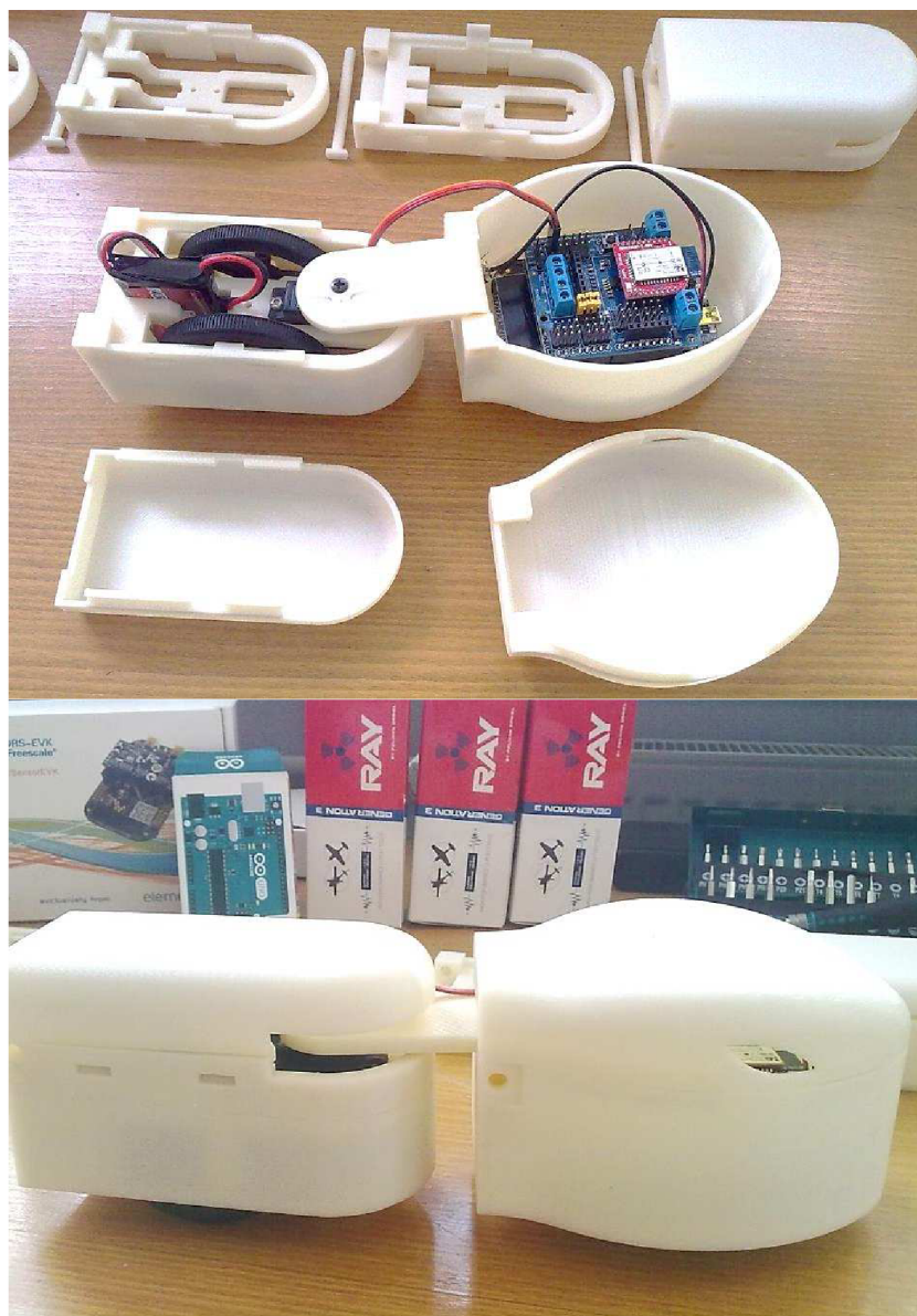
Obr. 28 Otevřená sestava článků hada (nahore), resp. finální vzhled článků hada
