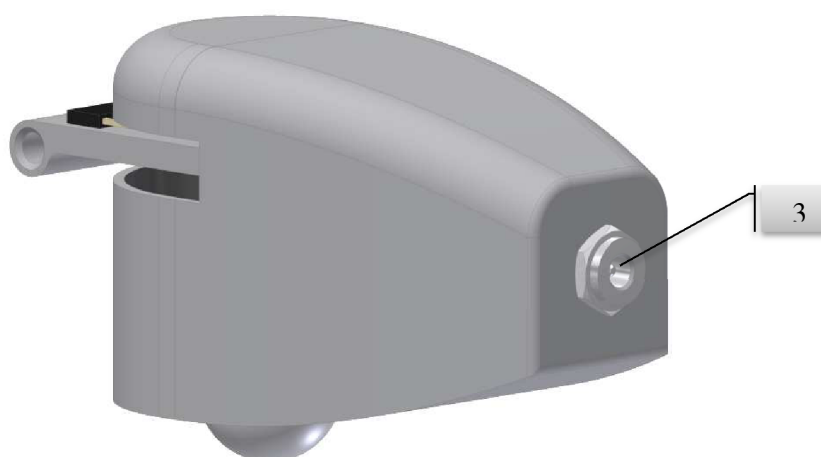
Obr. 20 Návrh posledního článku hada (ocas hada)
