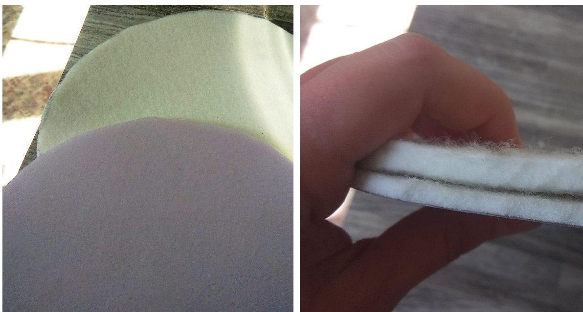
Obr. 31 Textilní polyesterové vystýlka a textilní polyesterová vystýlka s měkčenou polyvinylchloridovou vnitřní membránou pro nasycení vzorků
