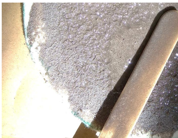
Obr. 39 Zbarvení a nasycení rukávce hmota Ashtech
