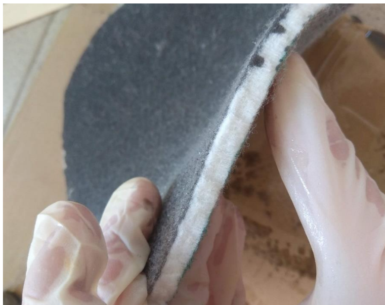
Obr. 33 Prostup syticí hmoty vzorkem (polymerní hmota Glasstech)
