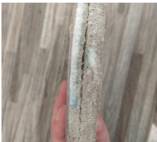
Obr. 39 Zbarvení a nasycení rukávce hmota Ashtech
