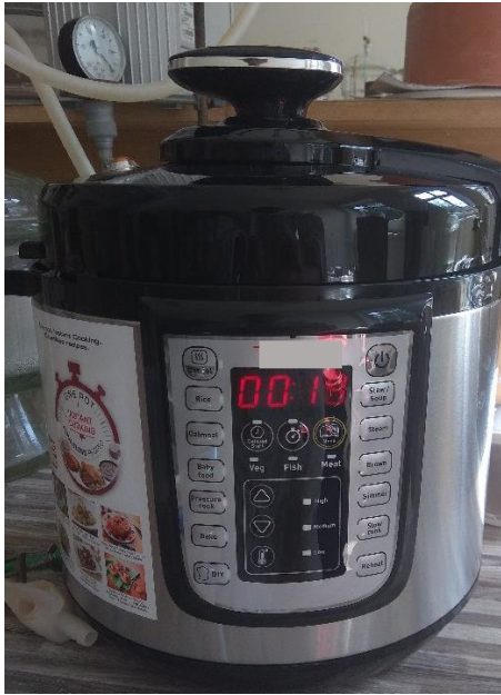
Obr. 34 Vytvrzování vzorků horkou parou v tlakovém hrnci
