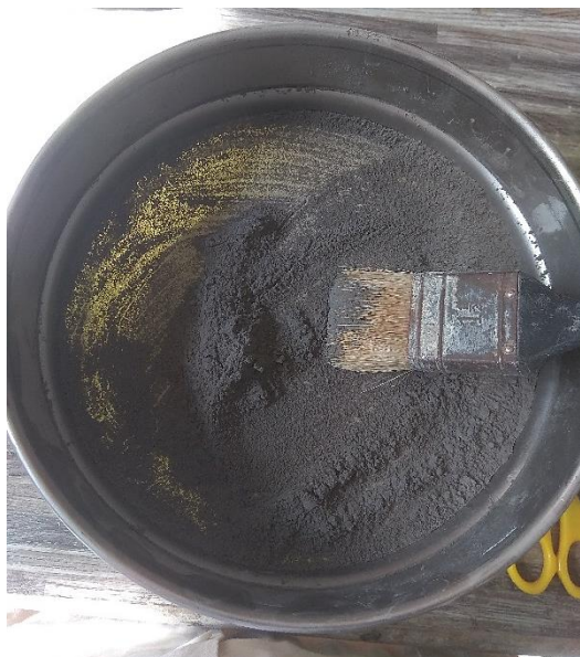
Obr. 30 Prosetí pěnového odpadního skla sítím 0,063 mm
