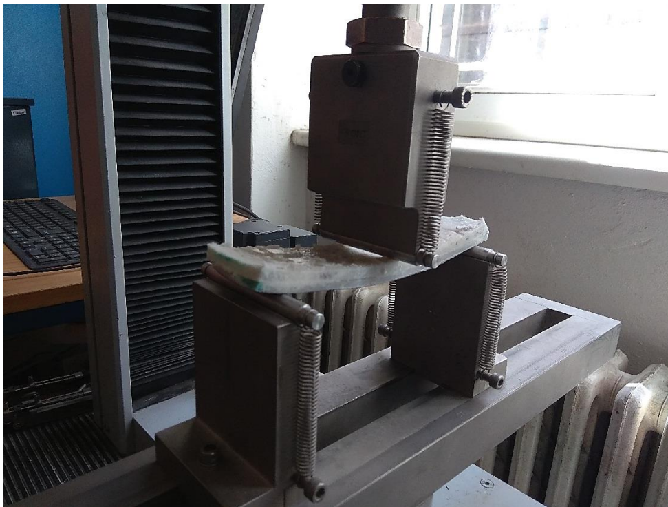
Obr. 42 Tříbodové ohybové namáhání
