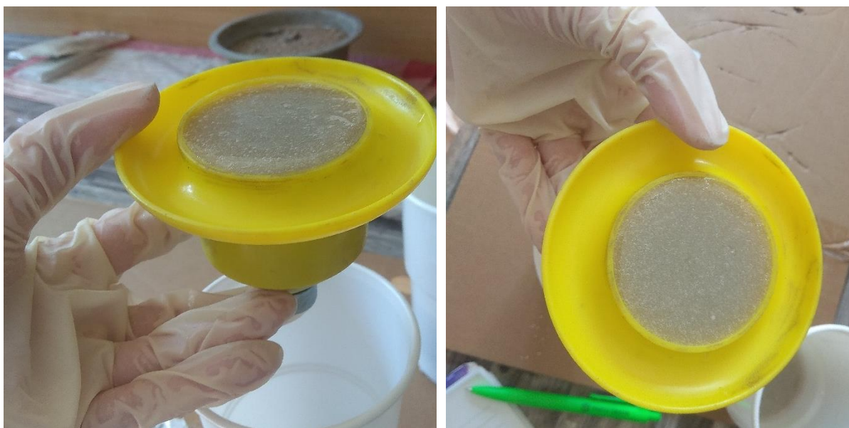
Obr. 36 Měření času výtoku hmoty z Fordova pohárku o průměru výtokového otvoru 12 mm – referenční směs
