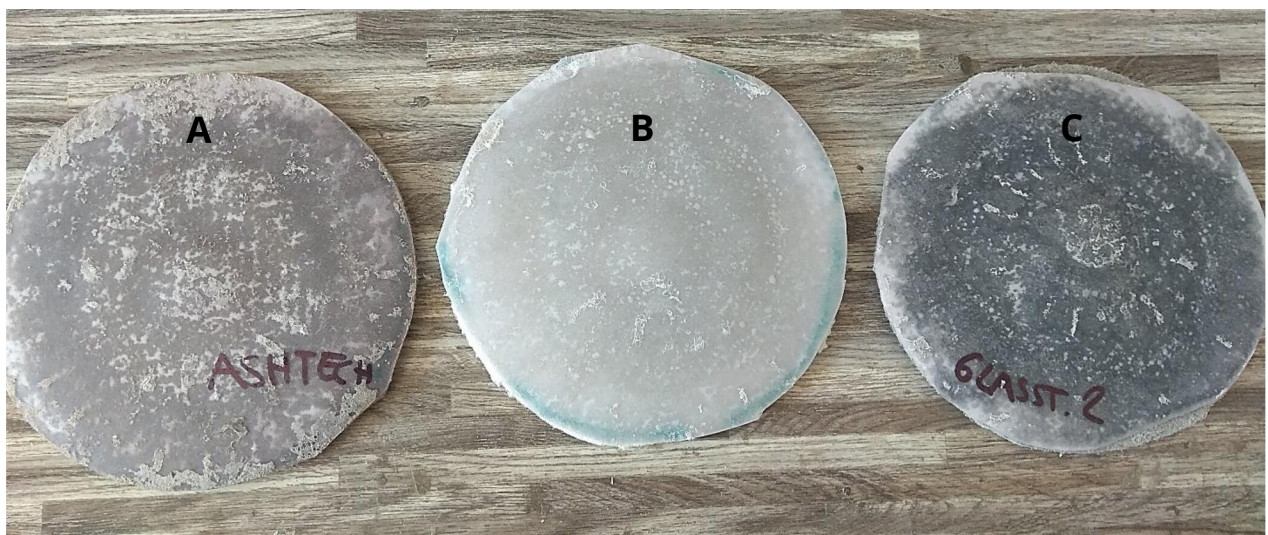
Obr. 35 Vytvrzené vzorky: (A) Ashtech, (B) referenční směs, (C) Glasstech
