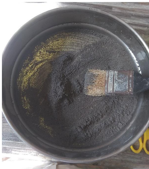
Obr. 30 Prosetí pěnového odpadního skla sítím 0,063 mm
