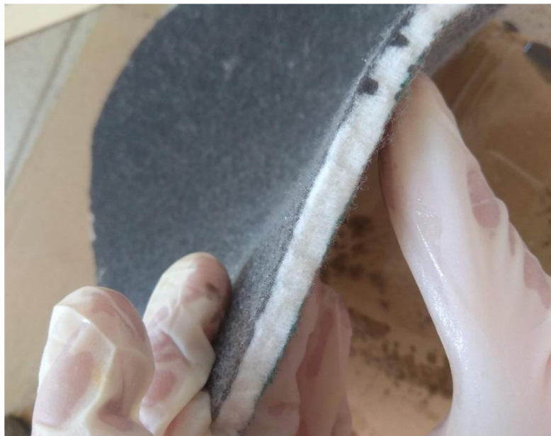
Obr. 33 Prostup sytící hmoty vzorkem (polymerní hmota Glasstech)
