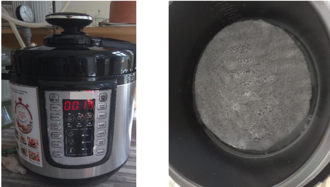
Obr. 34 Vytvrzování vzorků horkou parou v tlakovém hrnci
