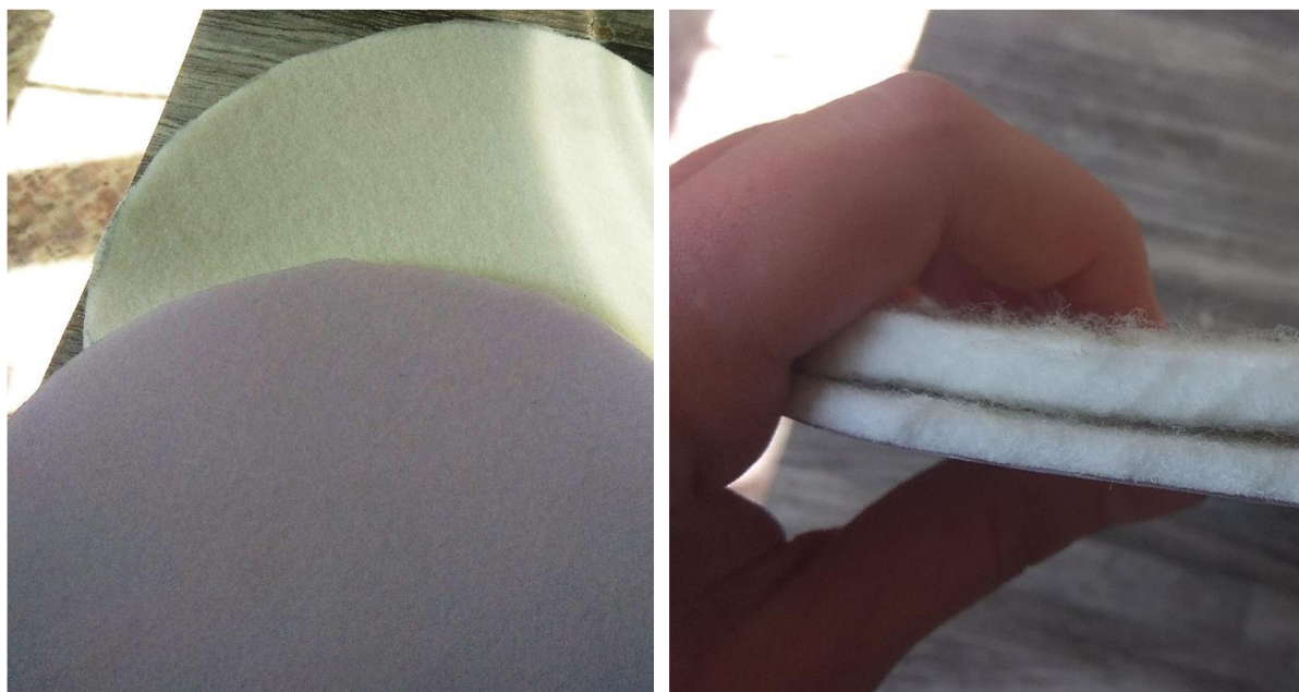
Obr. 31 Textilní polyesterové vystýlka a textilní polyesterová vystýlka s měkčenou polyvinylchloridovou vnitřní membránou pro nasycení vzorků
