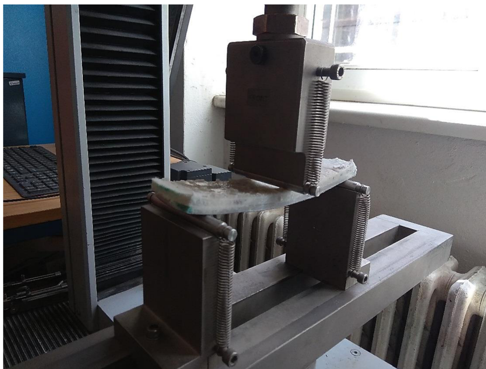
Obr. 42 Tříbodové ohybové namáhání
