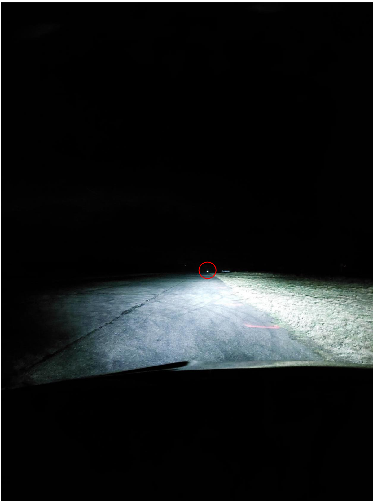
Obrázek 16: Viditelnost předmětu číslo 11 – záchranářská bunda – řidičem na vzdálenost 300 metrů při použití dálkových světel
