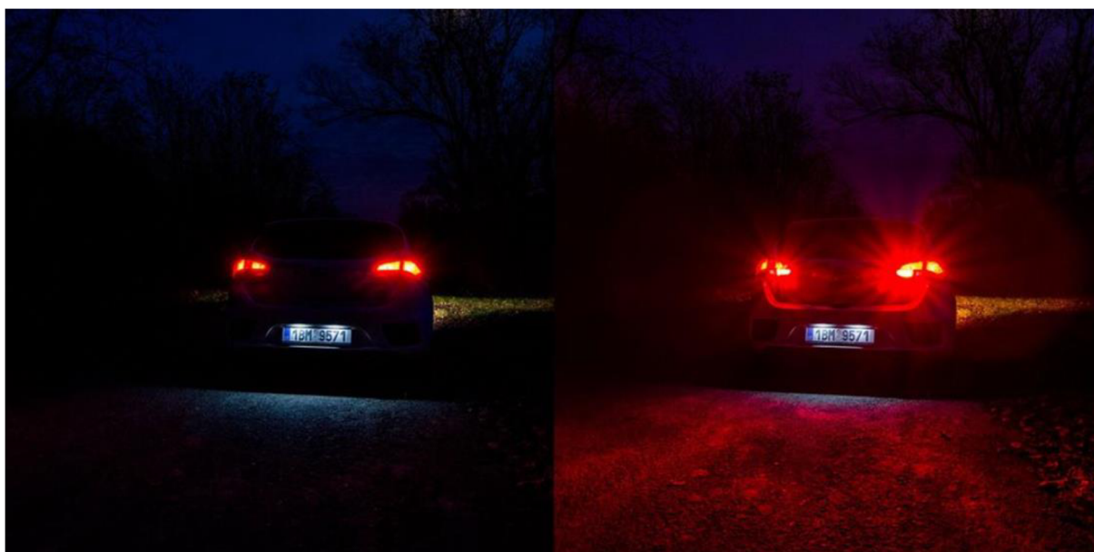
Obrázek 4: Rozdíl mezi vypnutými a zapnutými zadními mlhovými světly.
