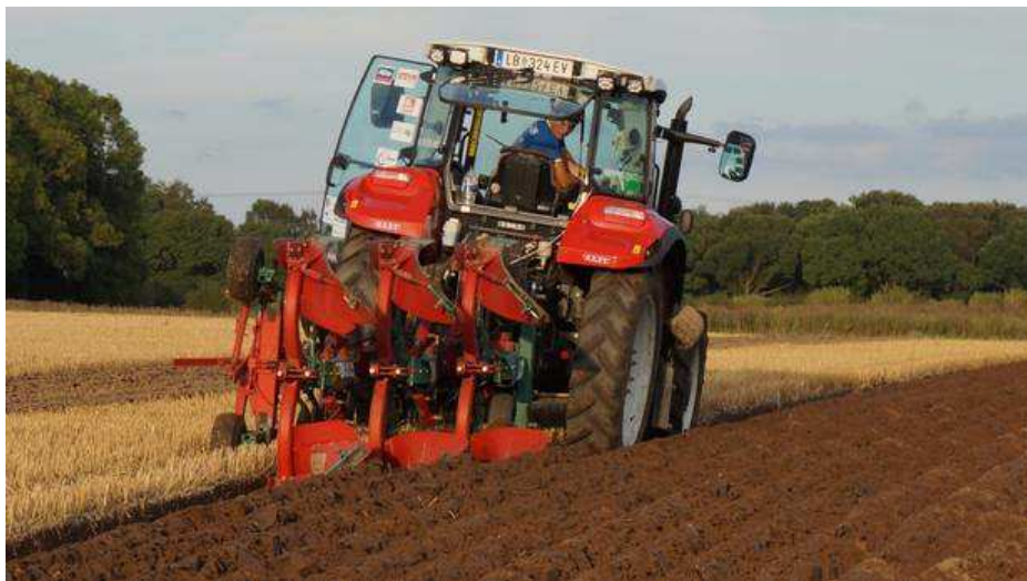
Obrázek 8. Příklad orby 3 radličným pluhem s kolami v brázdě.
