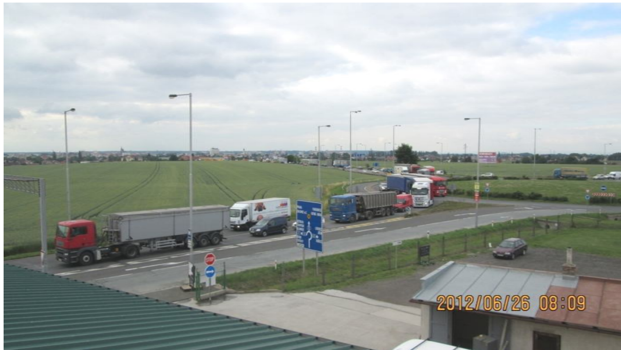
Obr. 5) Délka kolony vznikající na rameni ve směru na Náchod při zapnutém signalizačním zařízení na železničním přejezdu
